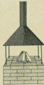
ildsted med aftræk
