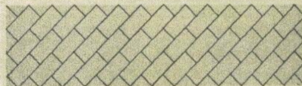
Klinker på fladen, \frac{1}{2} -stens forbandt, 45^\circ
