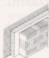
Mur af Hulsten nr. 9 perforation: 18% — dobbelt højde — normalformat 7 cm hulrum med 5 cm mineraluld
